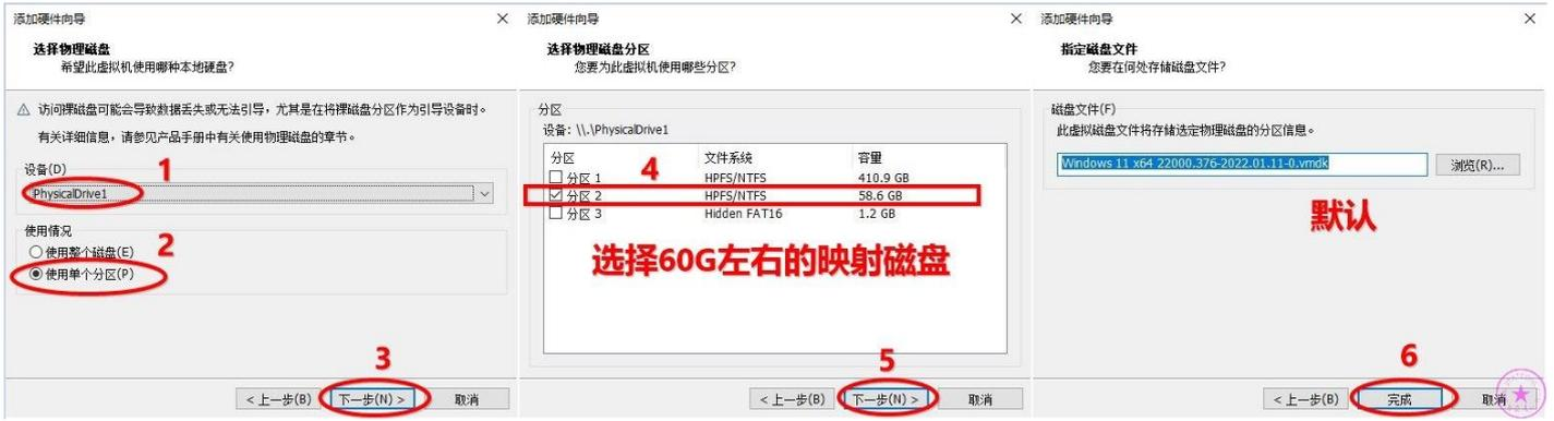
一定要将映射磁盘设置为永久独立磁盘，否则以后无法正常拍摄快照！将映射磁盘设置为独立磁盘后映射进虚拟机的物理磁盘就不受虚拟机快照的影响。应该说是不会影响虚拟机快照，不会被拍进快照。注意：设置独立磁盘之前不能有任何快照存在。若忘了设置独立磁盘，而且已经拍摄过快照了，那么物理磁盘将无法再设置为独立磁盘了，只能删了快照重新设置。最后点确定，虚拟机系统环境就配置好了。
